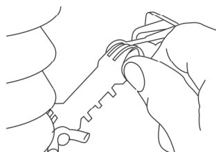
Připojte meteostanici k úchytku a nastavte do vertikální pozice
