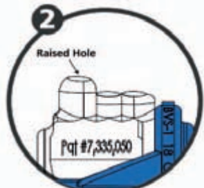
Krok 2 Vložte NEODIZOLOVANÉ vodiče nadoraz do konektoru
