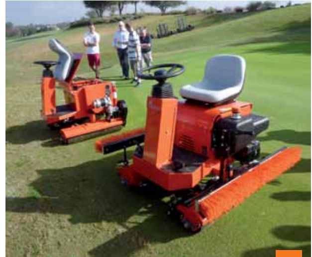
Válec greenů Smithco Ultra Tournament může mít jako příslušenství pasivní kartáče.
