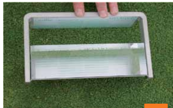
Hranol pro měření kvality stříhu
