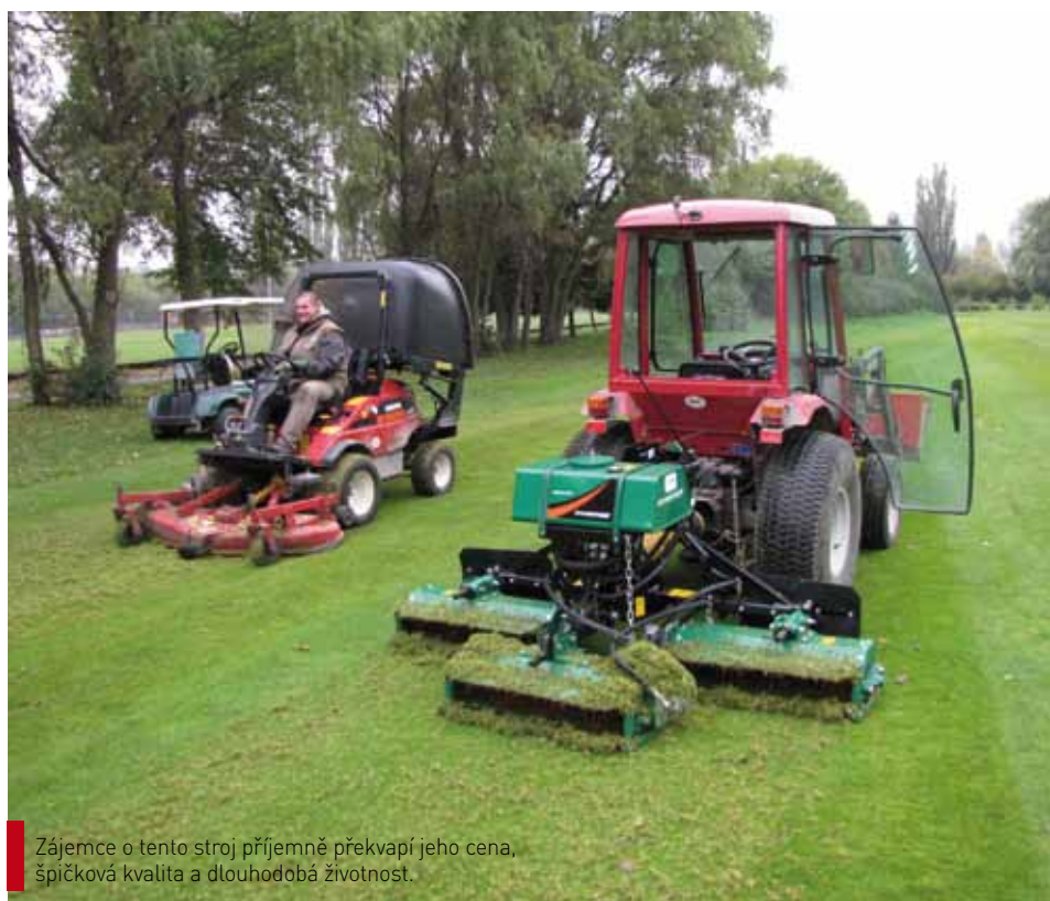
Každá ze tří volně plovoucích jednotek má na 18-ti discích namontováno 54 vertikutačních nožů.
