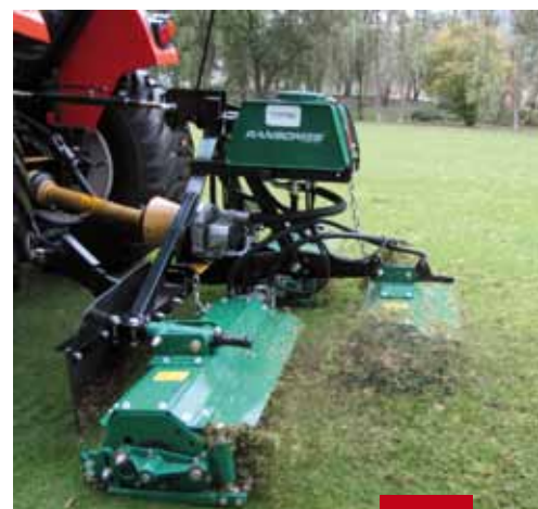
Každá ze tří volně plovoucích jednotek má na 18-ti discích namontováno 54 vertikutačních nožů.
