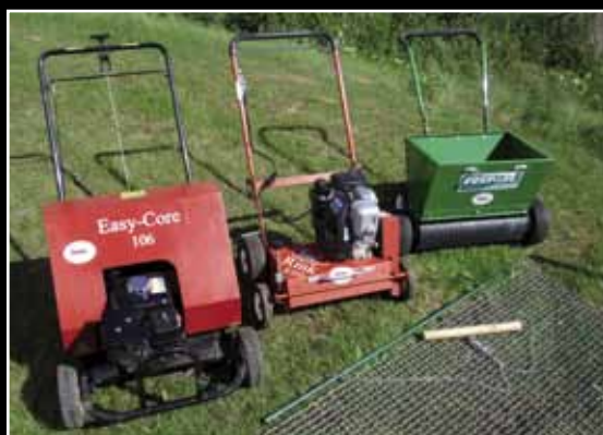
Aerifikátor Easy Core106, vertikutátor Rink S510, pískovač Rink ET240 a tažená síť dragmat pro regeneraci menších ploch
