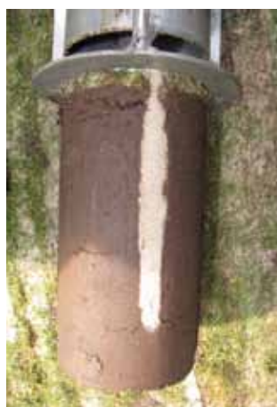
Green po provedení ošetření strojem Sand-Master prořezání do hloubky až 20 cm a vyplnění drážky pískem.
