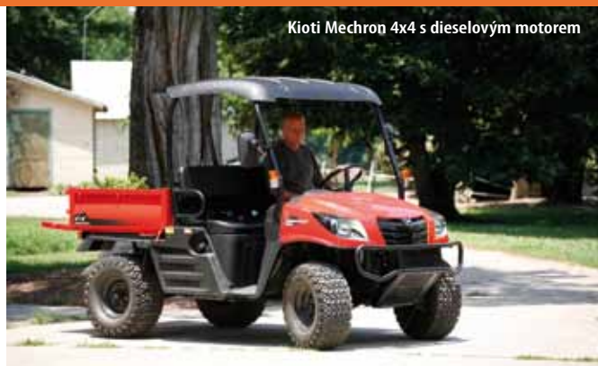
Hydraulické sklápění korby ulehčí práci obsluze
