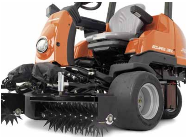
Na Eclipse 322 hybridní sekačku lze připojit všechny kazety Thatch Away Supa Systemu.
