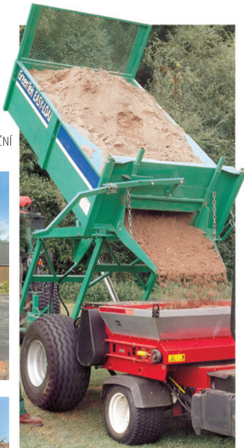
Vykládka písku přesně násypkou směřovaná do pískovače
